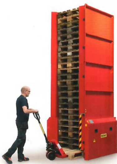
Der Palomat stapelt und entstapelt leere Europaletten als Palettenmagazin auf Bodenniveau.
